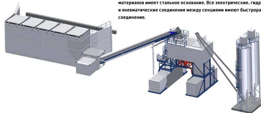
Оборудованные секции силоса инертных устойчивы к давлению грунта. Нижняя и верхняя секции устанавливаются друг на друга. Силос инертных материалов имеет стальное основание. Все электрические, гидравлические и пневматические соединения между секциями имеют быстроразъемное соединение.
