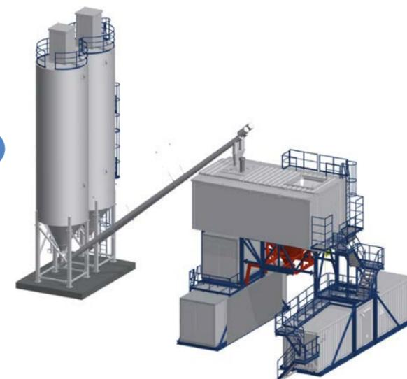
Цементные силосы крепятся к подвижному бетонному или стальному фундаменту. Шнековые конвейеры для цемента крепятся к потолку с помощью регулируемого быстрого зажима. Возможность расширения до шести силосов.
