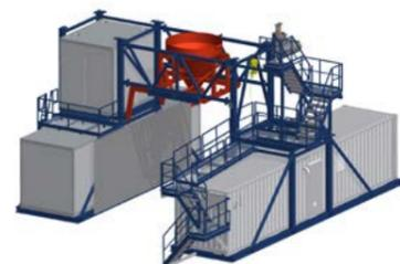
Распределительный щит и промежуточный бункер для товарного бетона соединяются с промежуточной секцией вместе с лестницей и уровнями. Промежуточный бункер можно легко опустить в положение промывки.
