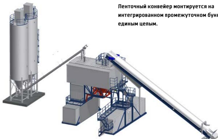
Ленточный конвейер монтируется на интегрированном промежуточном бункере единым целым.
